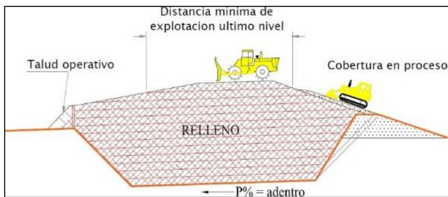
Figura 7. Esquema de compactación.
